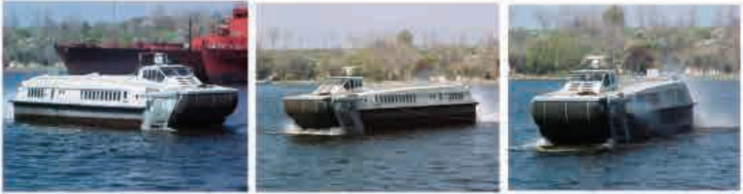
Probe de mars cu propulsie cu 2 elice supracavitante pe linii de axe inclinate 1604 M2
