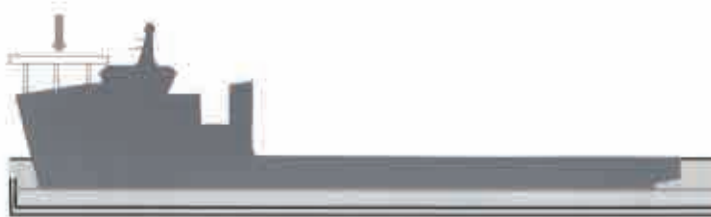
Montarea heliportului şi a coşului de fum
