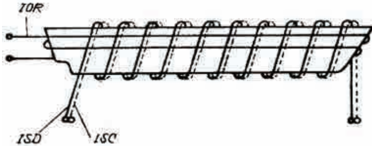
Fig.2.1.Înfășurările navei pentru demagnetizarea prin metoda impulsurilor.
