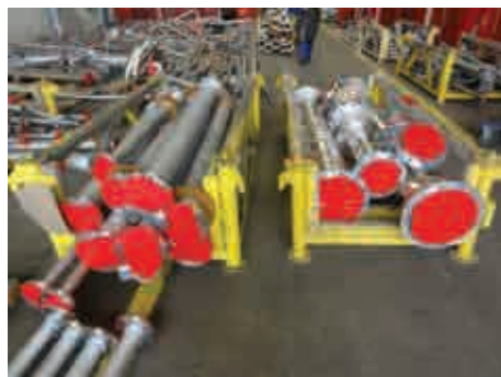
Containere cu țevi prefabricate și organizate pe secție de navă
