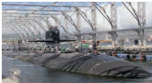
Fig. 2.8. Submarin US Navy, Clasa „Los Angeles”, într-un poligon specializat de demagnetizare.
